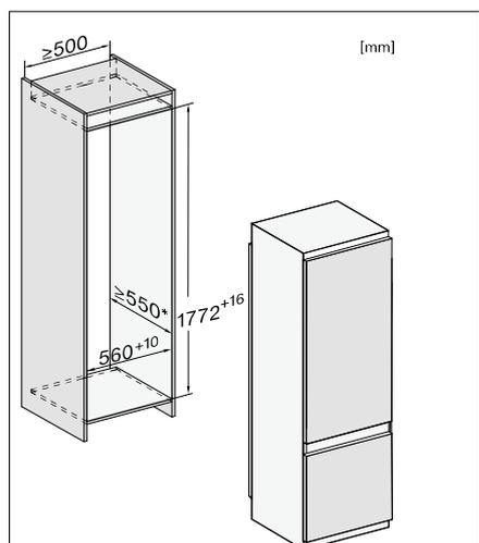
\* Der deklarierte Energieverbrauch wurde mit einer Nischentiefe von 560 mm ermittelt. Das Kältegerät ist bei einer Nischentiefe von 550 mm voll funktionsfähig, hat aber einen geringfügig höheren Energieverbrauch.
